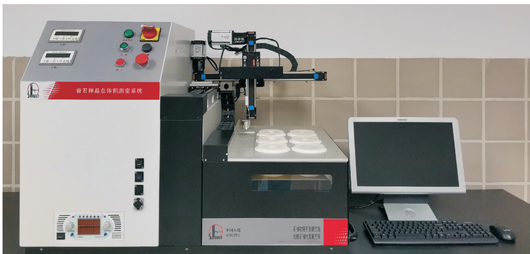
图1 第Ⅱ代岩石样品总体积测定系统
