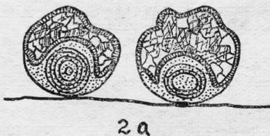
图 2a 成岩作用的变形和镶边(根据薄片观察)
