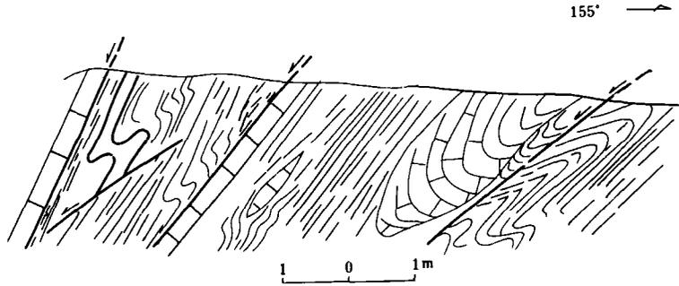
图5 棕冶过滑脱断层带素描图
