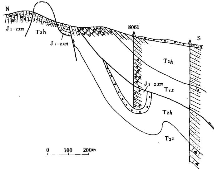
图7 杨坊山逆冲断层剖面图
