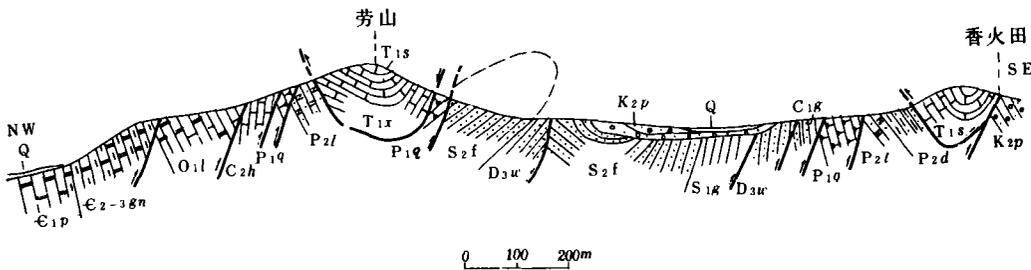
图6 幕府山构造剖面图(示向形滑块构造)
