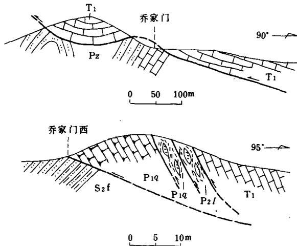
图8 乔家门逆冲断层剖面图
