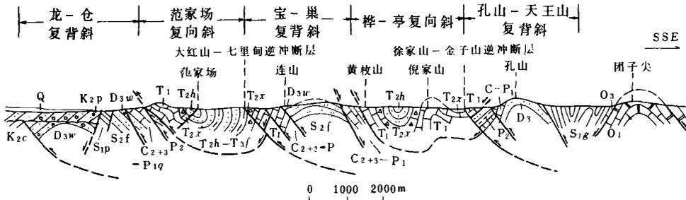
图1 宁镇山脉构造剖面示意图
