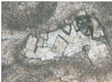
E. J43-17, 飞三段(3 036.2 m), 亮晶鲕粒灰岩, 粒内溶孔中充填萤石和白云石。10×10
