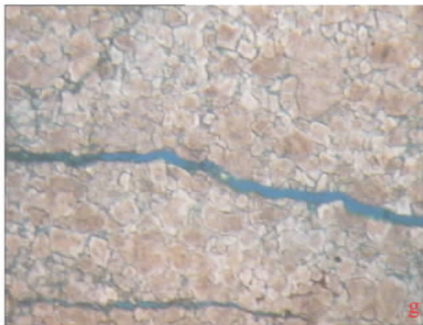
g. 贵州南部广顺漫滩中泥盆统粒屑白云岩, 岩石中晶间孔隙及裂缝发育 (放大倍数10×5)
