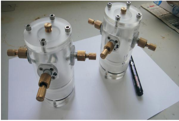
图1 烃类微渗漏实验模拟用的小型装置
