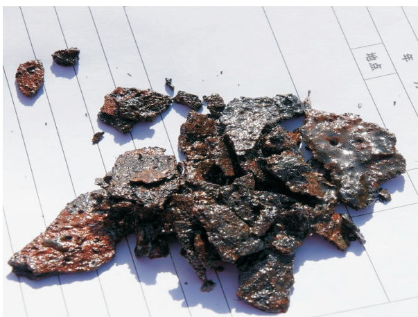
图2 塔河油田 T801(K)井油管壁剥落片状锈垢
