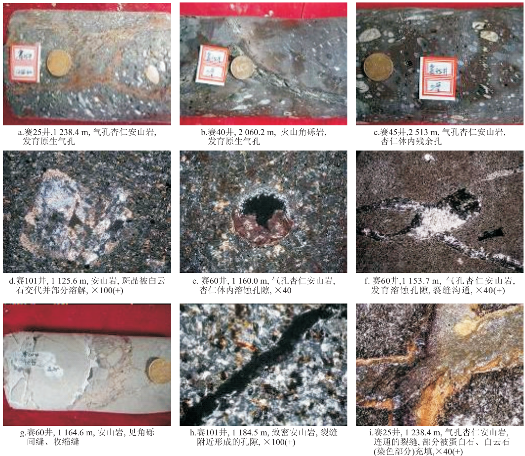
图4 二连盆地赛汉塔拉凹陷白垩系火山岩储集层储集空间特征
