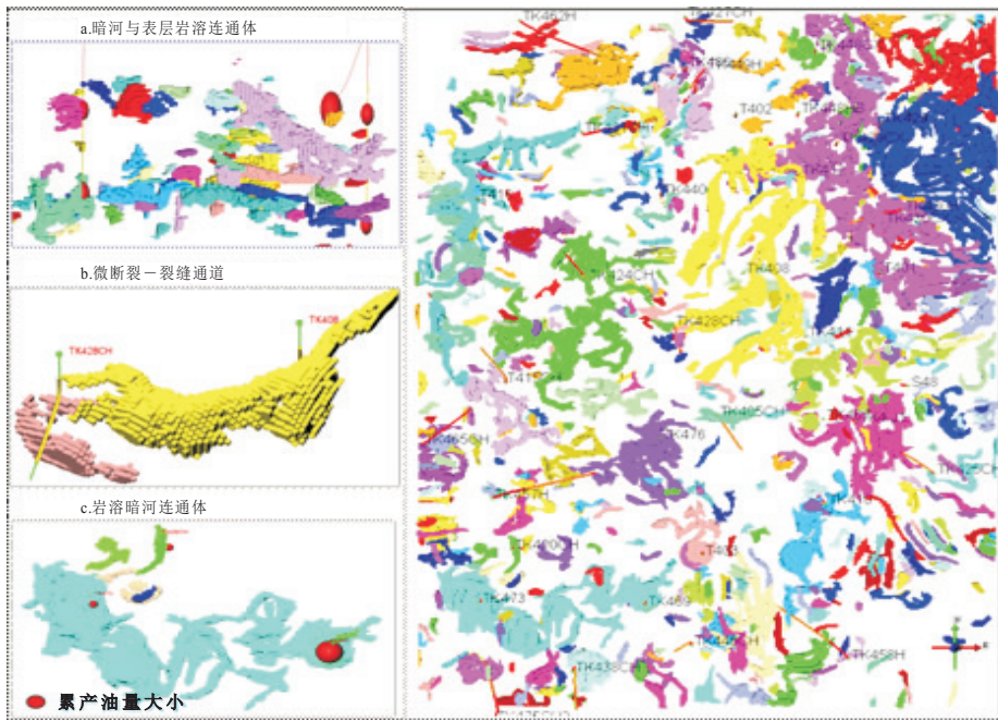
图 4 S48 单元内部缝洞连通体平面展布 不同的颜色代表不同的连通体。
