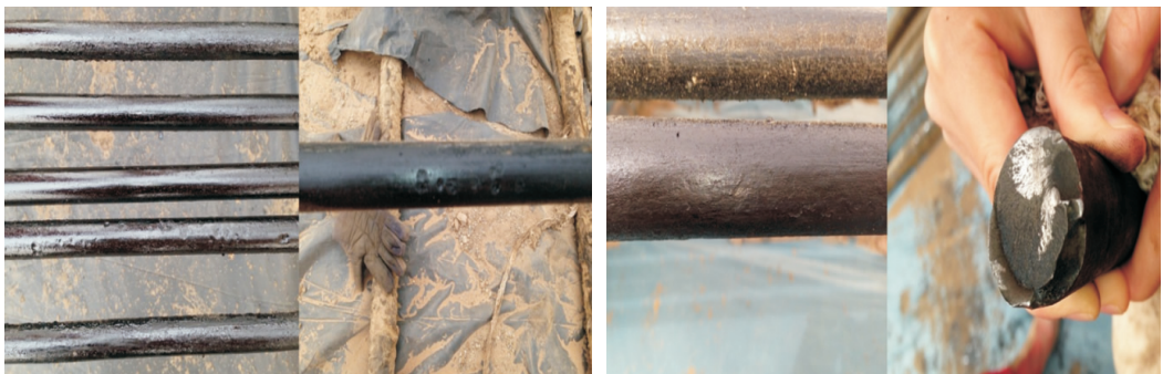
a. 断裂抽油杆上的坑状腐蚀
