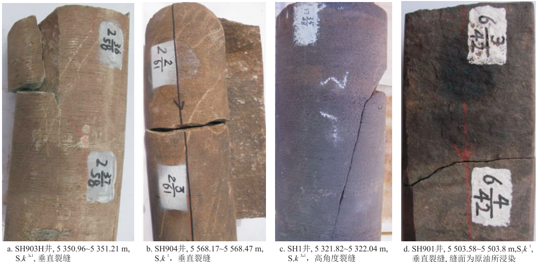
图 2 塔中北坡柯坪塔格组裂缝岩心发育特征
