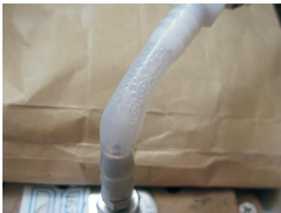
图5 高温解吸水蒸气在出气口冷凝堵塞
