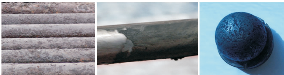
图 1 单井注气三采井油管和泵的结垢腐蚀
