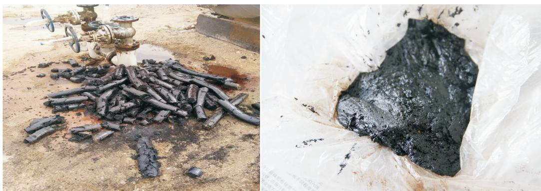
图 1 管线中扫出堵物及外观
