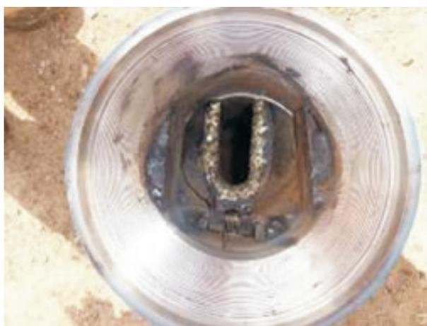
图 3 新型抽油杆打捞筒实物
