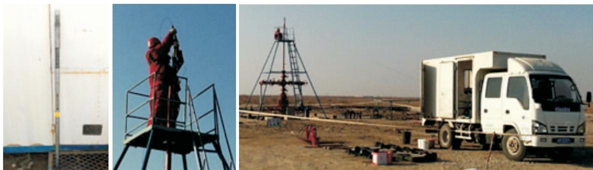
图 4 井下液面自动取样器现场试验
