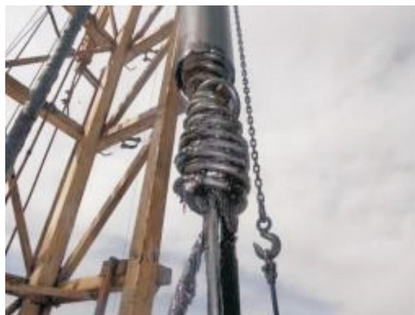
图 4 捞获弯曲抽油杆实物
