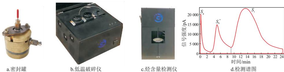
图1 井场岩石密闭热释分析系统的构成
