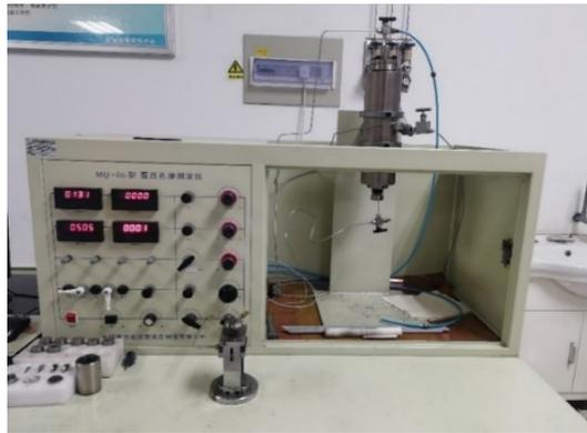
图 1 MQ-86 型覆压下孔渗测定仪
