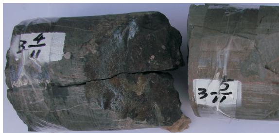
BK2井,第3回次,层位C,b,井深4767.52~4767.81 m; 4~5段: 上部灰色油斑微晶白云岩,下部灰色油斑膏质白云岩。裂缝发育岩心破碎。
