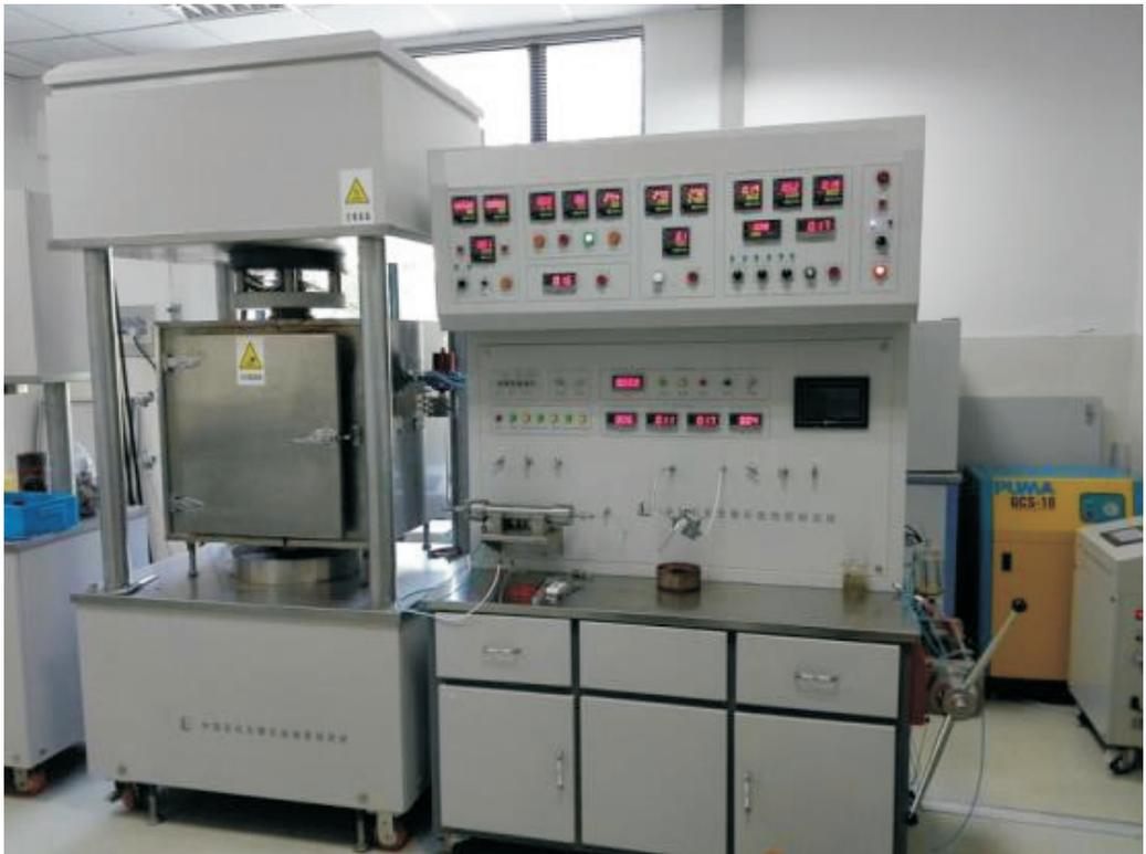
图 1 源—储协同演化模拟实验装置
